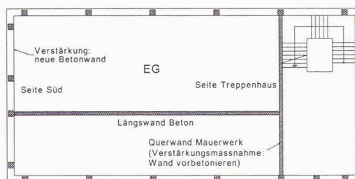
2 Typische Gebäudegrundrisse mit den getroffenen Massnahmen
