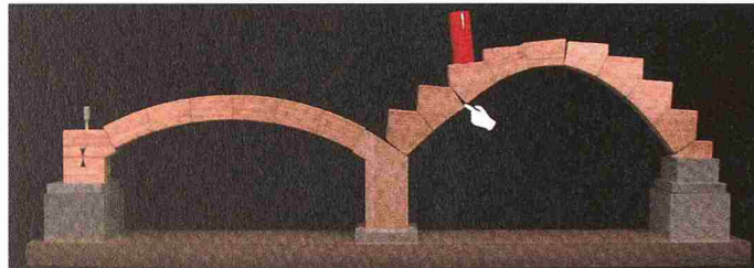
Statik anschaulich demonstriert an Tragwerksmodellen: Bei punktförmiger Belastung muss ein Bogen nicht nur Druck-, sondern auch Biegemomente (Zug und Druck) aufnehmen können (Bild aus dem besprochenen Buch)
