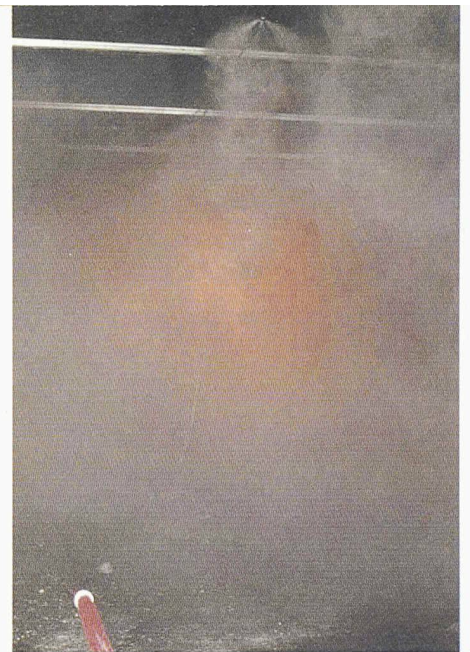
Wassernebeldüse in Aktion (Bilder: Versuchsstollen Hagerbach)
