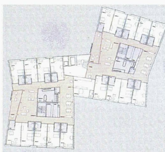
Der Kern mit Nebenräumen trennt das Wohnzimmer vom Essbereich (1. Rang nach der Überarbeitung, Zach + Zünd)
