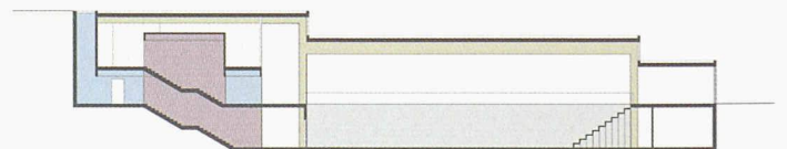
Die gestaffelte Sporthalle passt sich der Hangkante an (1. Rang, Lauener + Baer + Architekten)
