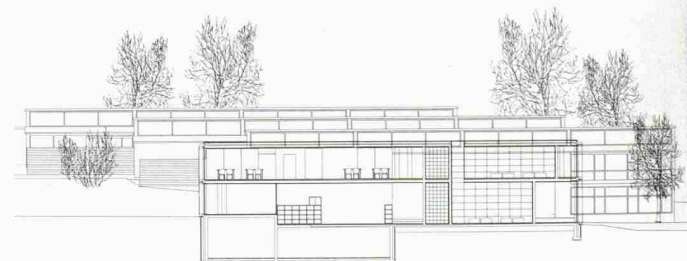
Schnitt durch die terrassenartige Abstufung
