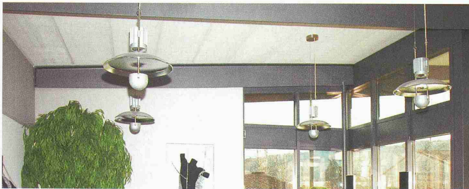
4 Moderner Wohnraum mit Akustikdecke aus mitteldichter Faserplatte (MDF, vorne geschlitzt und hinten gelocht); 2004
