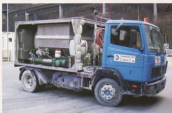
Sprengmobil in Faido mit Misch- und Ladeeinheit (Bilder: Zschokke Bau AG)
