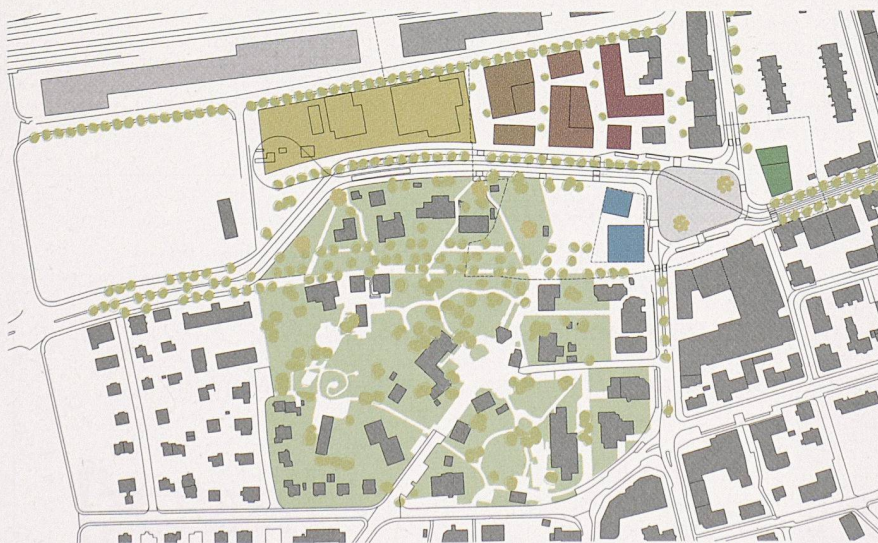
Die Verlegung der Badenerstrasse nach Norden fasst alle Altbauten im Stadtpark zusammen. Am Platz mit Läden und ÖV-Haltestellen stehen die Stadthalle (blau) und das Hotelhochhaus (grün)
