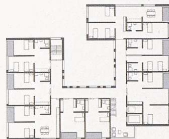
Eines von drei Gebäuden. Das Obergeschoss als Beispiel mit dem Pflegegrundriss (Weiterbearbeitung, A. D. P. Walter Ramseier)
