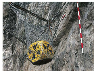
Test bestanden – der Prüfkörper hängt im Netz (Bild: Autor). Rechts: Bremsringe ziehen sich bei grosser Kräfteinwirkung zusammen (Bild: Geobrugg)
