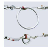
Test bestanden – der Prüfkörper hängt im Netz (Bild: Autor). Rechts: Bremsringe ziehen sich bei grosser Kräfteinwirkung zusammen (Bild: Geobrugg)
