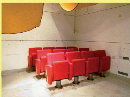
02 Raumakustisches Computermodell (Bild: Autor) 03 Hallraummessungen an neu entwickelten Stühlen für einen Konzertsaal (Bild: Autor)
