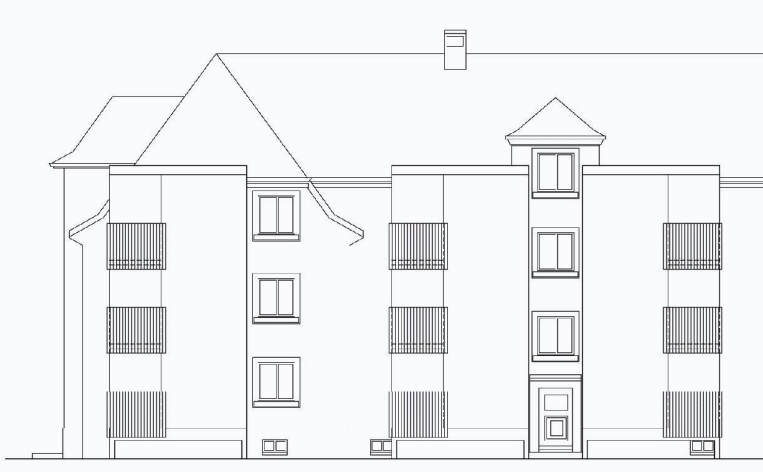
Areal 1, 1. Rang (Märkli): Nordfassade mit vorgeschalteten Balkonsegmenten
