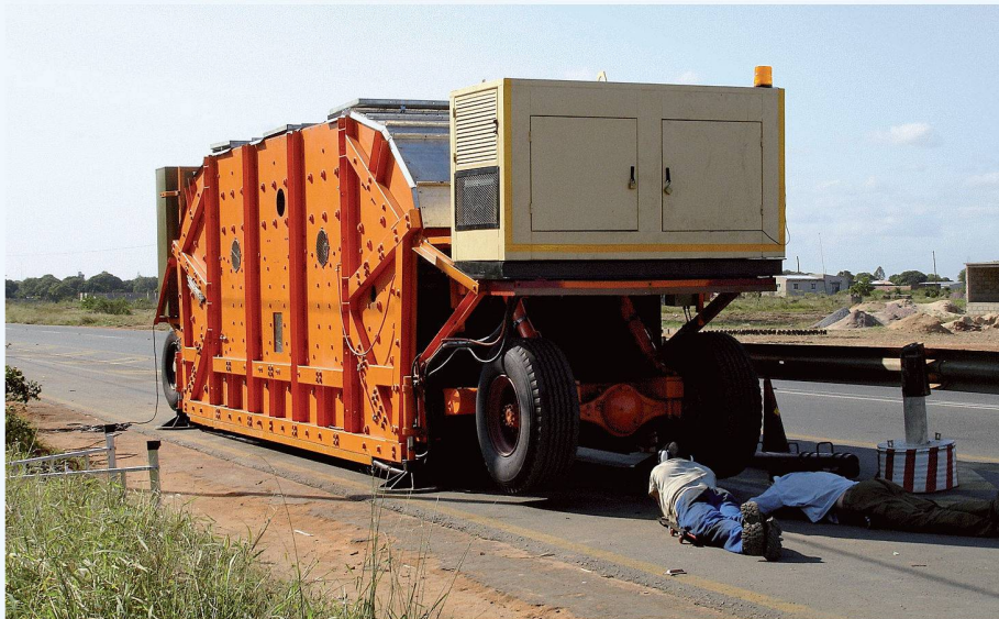
Erster Test in Moçambique zur Demonstration, wie effektiv der Simulator Strassen zerstören kann. Vier Lasträder auf einer Schiene simulieren 6000 Überfahrten pro Stunde (Bild: Empa)
