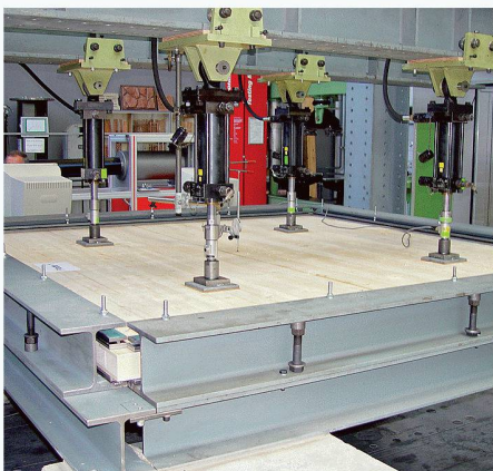
Förderpreis: Bestimmen der Steifigkeiten von Holzplatten. Arne Gülzow, Daniel Gsell, René Steiger, Empa (Bild: Empa)
