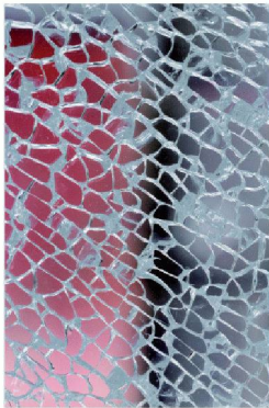
Zerschlagenes laminiertes Glas einer Telefonkabine (Bild KEYSTONE/Jeremy Burgess)
