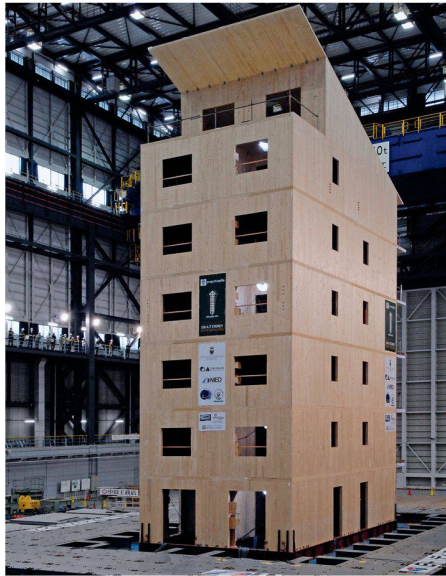
01 Auf dem 300 m 2 grossen Schütteltisch des japanischen Forschungsinstituts NIED können Erdbeben jeder Stärke simuliert werden. Das siebenstöckige Haus in Holztafelbauweise hat sich dabei als überraschend standfest erwiesen (Bild: Romano Magrone)
