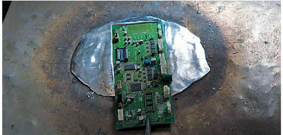
01 Computer-Mainboard wird in heissem Metall erhitzt, um die Lötstellen zu lösen (Foto: Time)
