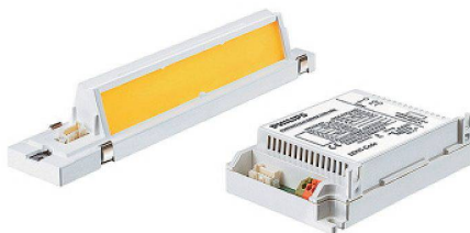
01 Im neuartigen Leuchtentyp wird das bläuliche Licht der LED erst gemischt und dann gesammelt durch einen phosphorbeschichteten Diffusor geschickt. So kann die Aussortierung weisser LED umgangen werden, es entsteht ein homogenes weisses Licht (Foto: Autor)
