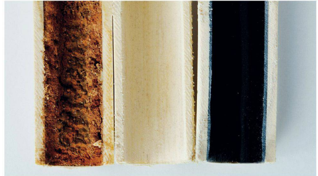
Heizungsrohr vor, während und nach der Sanierung.
