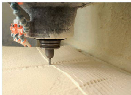
03 Erstellung des physikalischen Modells in der Fräse.
