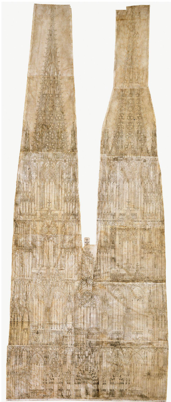
Ansicht der Westfassade des Kölner Doms. Architektur und Zeichnung: Meister Arnold um 1280. 166,5 × 406,5 cm, Eisengallustinte auf Pergament, Massstab vermutlich 1:36, Bauzeit: 1248–1880.
