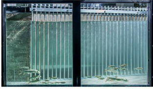
Der Modellversuch mit lebenden Objekten bildet die Ausnahme. Wenn jedoch das Verhalten von Fischen untersucht werden muss, führt kein Weg daran vorbei. Das Coverfoto stammt von einem Modellversuch in Zusammenarbeit zwischen Eawag und VAW .
