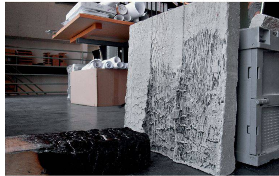
Erste Testergebnisse mit versengten Gipsplatten stehen im Büro.
