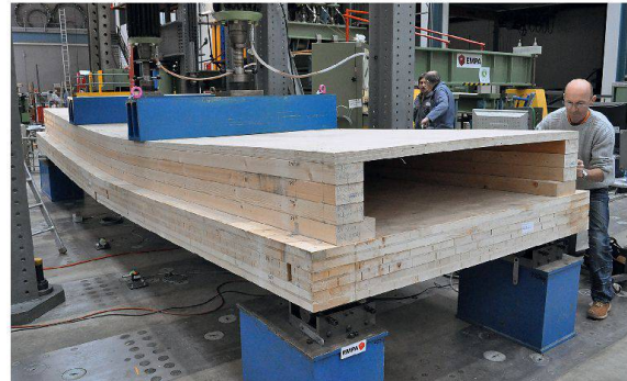
Oben: Visualisierung des achtstufigen Berechnungsmodells. Die Verbindungen wurden mit Federn modelliert, deren Steifigkeit anhand von Materialversuchen an der Empa ( Abb. darunter ) kalibriert wurde.
