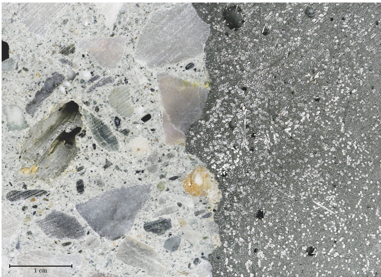
Konventioneller Beton (links) und Ultrahochleistungs-Faserbeton oder «faserbewehrter Zement» (rechts).
