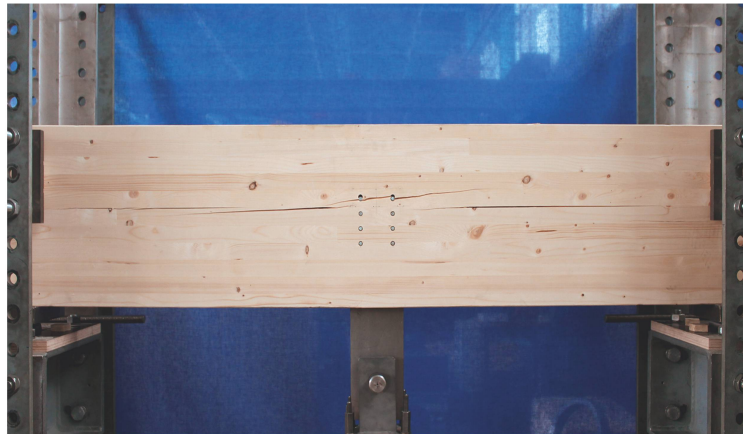
Risse im Balken: Querzugversagen eines Queranschlusses mit rechtwinklig zur Faserrichtung belasteten Stabdübeln – Versuchsaufbau an der ETH Zürich.
