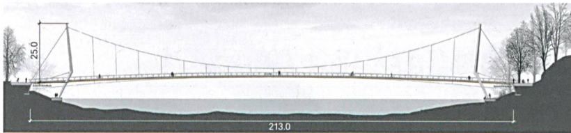
1. Preis: «1001»: einfeldrige Hängebrücke ( l/h = 8.5 ) mit zwei Stahlpylonpaaren und Fahrbahn in Stahl-Holz-Verbundbauweise.
