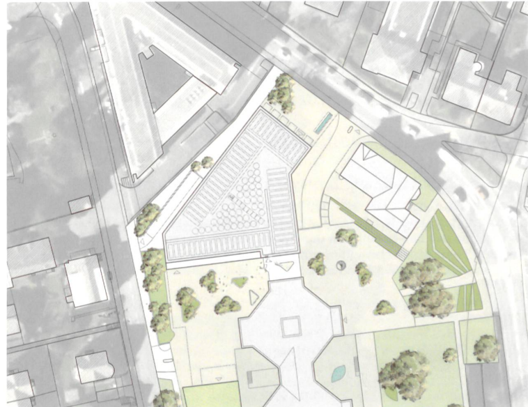
«Euklid» auf dem 3. Rang fügt sich massgeschneidert in die Situation ein und dockt sogar an den bestehenden Buchenhof an. Die souveräne volumetrische Geste wird durch die Rampen der Tiefgarage geschwächt, die an beiden Seiten des Gebäudes einen Graben bilden. Die grosszügige Erschliessung bildet einen attraktiven Raum, der aber die Effizienz schmälert. Situation und Grundriss 1. OG im Mst. 1 : 1500.
