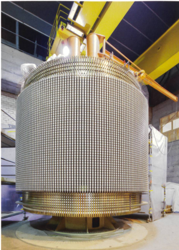
Rotor eines der vier Motorgeneratoren. Ein Rotor allein wiegt 330 t und besteht aus 0,5 mm starken, aufeinandergeschichteten Blechen.
