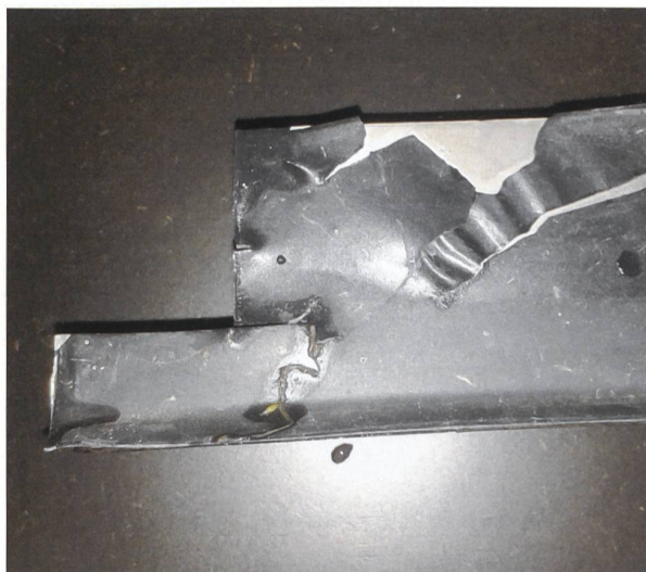
An einem Metallbauteil löst sich die Lackierung.
