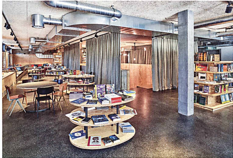
Mittels akustisch wirksamer Stoffe kann der Buchsalon vom Veranstaltungsbereich getrennt werden.
