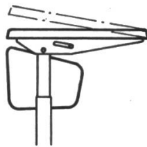
Höhenverstellung mit Klemmbolzen
