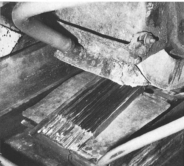
5a die Blattseiten mit der Schleifmaschine schleifen
