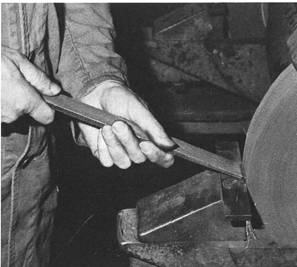
8b mit der Schleifmaschine abstossen
