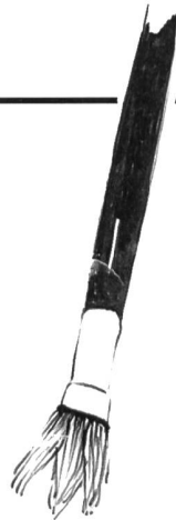
verklebt Lack-, Leim- oder Farbpinsel nicht gereinigt
