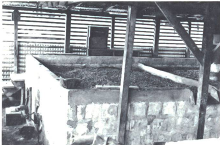
19 Häufig wird lediglich an der Sonne vorge-trocknet und nachher künstlich nachgetrock-net. Dafür werden Trockentrommeln oder, wie im Bild, Trockentische eingesetzt. Es muss sehr vorsichtig vorgegangen werden, denn die Temperatur darf 55 Grad nicht übersteigen.
