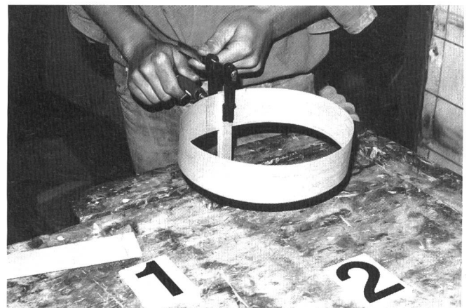
Falls wir einen Schraubstock oder eine Hobelbank zur Verfügung haben, spannen wir nun die beiden Enden der Leisten in die Zwingen. Andernfalls spannen wir die beiden Leisten mit einer Schraubzwinde zusammen.
