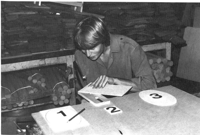
Aufzeichnen der Form mittels Schablone auf den Boden. Aussägen mit Laubsäge (grobes Blatt, z.B. Nr. 7).
