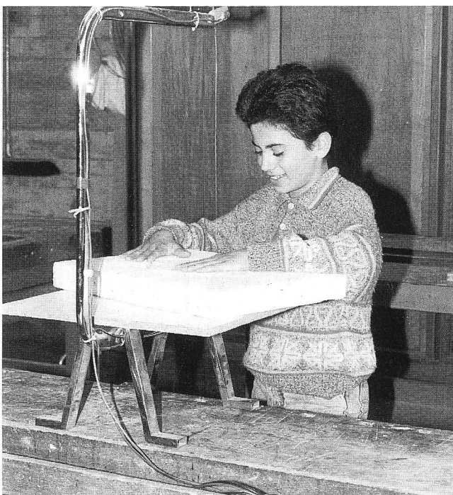
Aussägen der Betongussform mit Thermosäge
