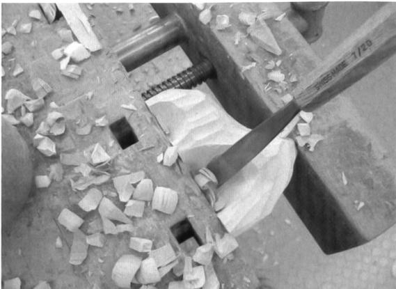
Es folgt schnitzerische Feinarbeit ohne Klöppel. Von Hand wird nun die ganze Höhlenform so beschnitzt, dass die Schnitte sauber und schön wirken. So wird sozusagen die Wirkung erzielt. Es können nämlich auch Flächen oder Kanten geschnitzt werden, die dem Lämpchen seine Wirkung verleihen. Dieser Arbeitsschritt fordert Geduld und manch ein Kind wird hier feststellen, dass es für einen sauberen Schnitt immer wieder die Schnitzrichtung wechseln muss.
