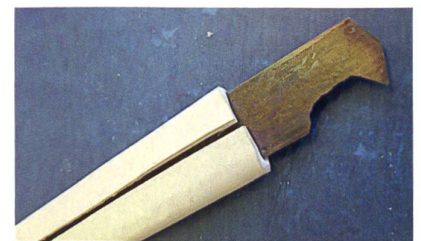
Drei Messervarianten aus alten Sägeblättern.
