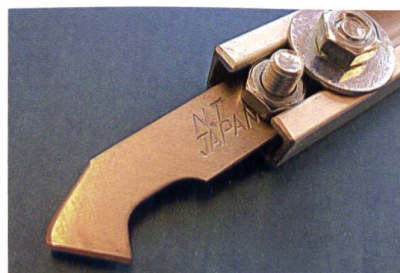
Messer mit konfektionierter Klinge, Griff aus Vorhangstange.
