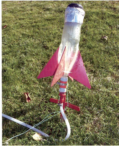
Auslösung mit Gartenschlauchanschlüssen (relativ teure Variante!).
