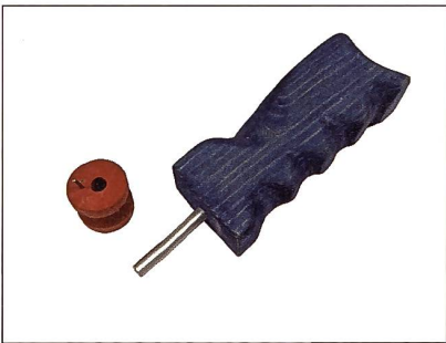
Abb. 4: Starthilfe mit einer Metallachse und einer aufgesteckten Spule mit einem Mitnehmer. Spule und Propeller können ausgetauscht und mit anderen Modellen getestet werden.
