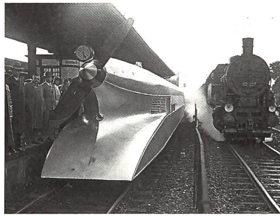
Abb. 2: Schienenzeppelin aus dem Jahr 1929: Mit 230 km/h stellte diese Eisenbahn einen Geschwindigkeitsrekord auf, der 24 Jahre lang Bestand hatte (Foto Bundesarchiv Berlin).
