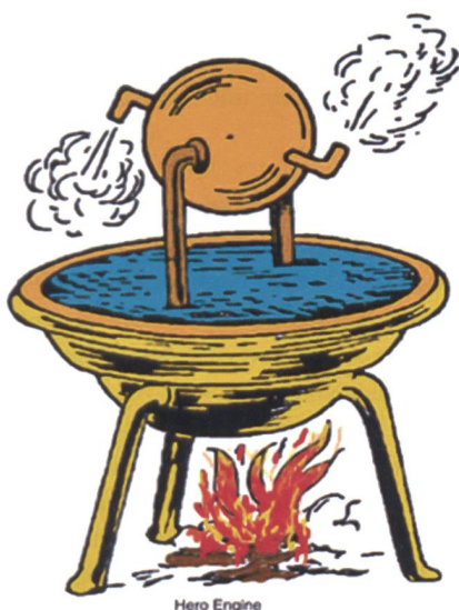
Der Heronsball funktionierte dank des Rückstossprinzips.
