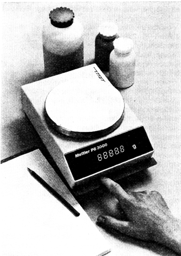
Abb. 1: Eine Mettler PB-Waage mit der 1-Tasten-Automatik: auflegen und ablesen. Wägebereich bei der abgebildeten Ausführung: 0...3700 g; Ablesbarkeit bei den drei PB-Modellen: 0,1, 0,01 und 0,001 g.
