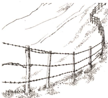
Fèllhag : Zaun aus Latten und gabelförmigen Stützen ( G[g]riggälä ) oder auch aus Pfählen mit (Stachel-)Draht bestehend. Dieser wird zur Winterszeit niedergelegt oder gefällt ( fèllä ).
