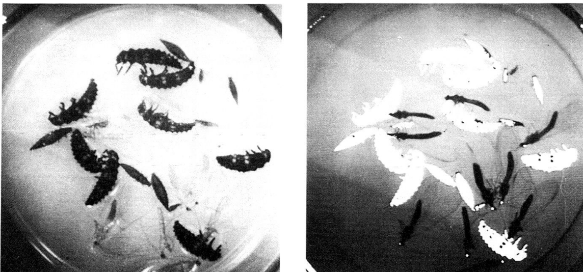
Abb. 5: Monitoraufnahme der Probe im Auflicht, ohne Filter: links das Grauton-Bild, rechts eingeleitet das digitalisierte Bild (weisse Flecken).
