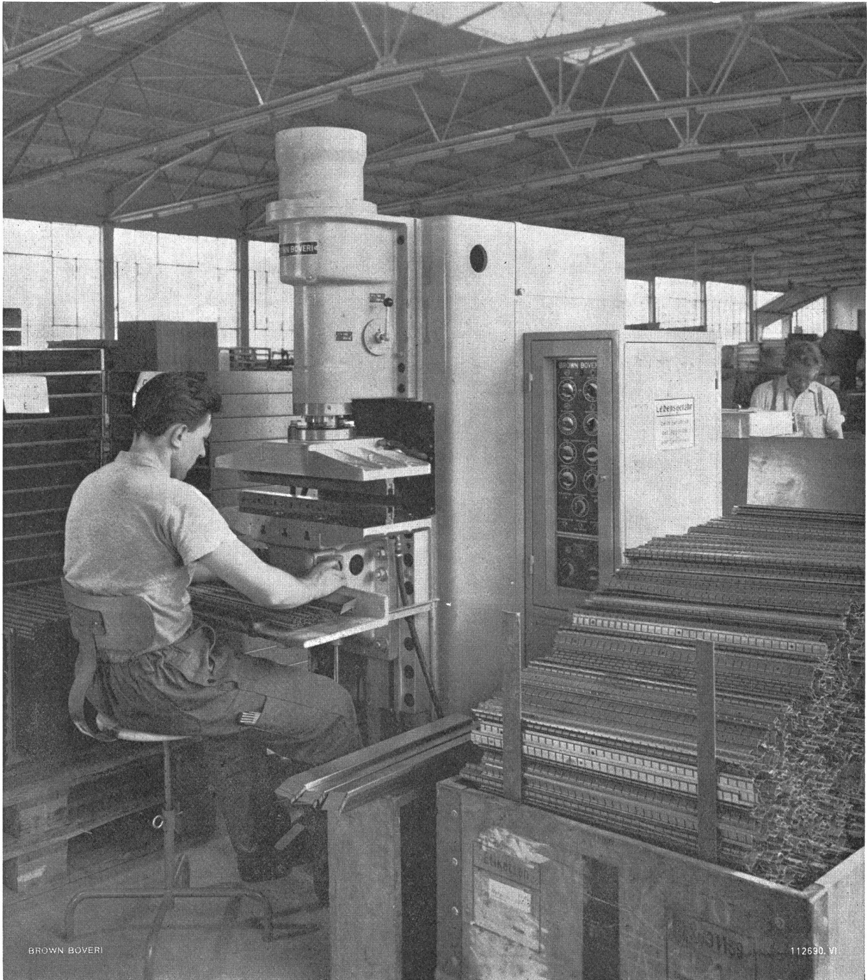
Brown Boveri Buckel-Schweisspresse mit elektronischer Steuerung beim Schweißen von Bestandteilen zu Werkzeug-Schubladen
