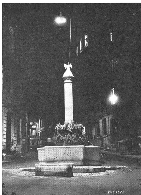
Fig. 12 Brunnen Grand-Mézel in Genf Beleuchtung durch eine einzige hängende Glühlampe 200 W, 36 V
