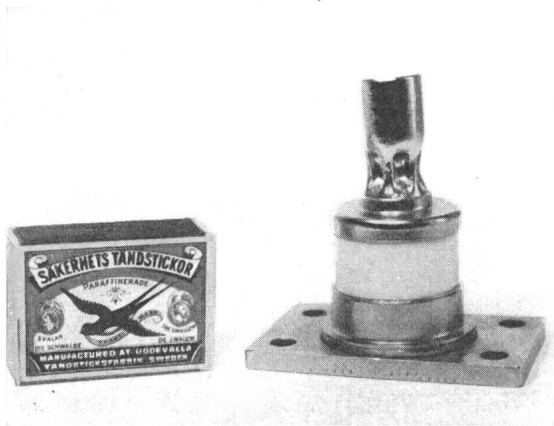
Fig. 1 Si-Leistungsdiode für 250 A, 1200 V -
