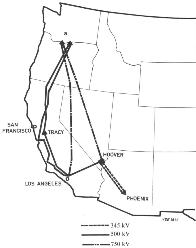
Fig. 12 Die geplanten Fernleitungen längs der Westküste a Wasserkraftgebiet des Columbia-Flusses w und g Wechsel- und Gleichspannung
